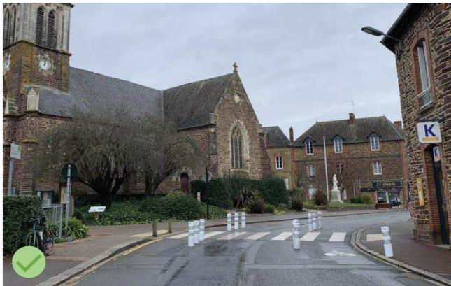
Écluse pour ralentir à l'approche d'un passage piéton avec passage alterné en zone 30 – Le Rheu (35)
